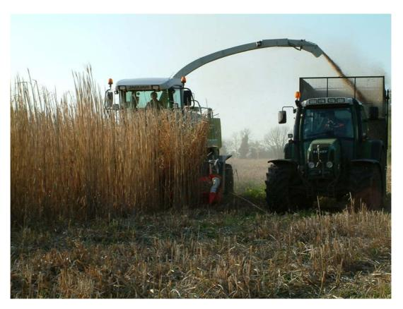
3 Fauché, conditionné puis bottelé pour le transport, et déchiqueté le cas échéant sur le site de consommation. (Processus plus coûteux réservé aux longues distances ou capacités de stockage insuffisantes)
